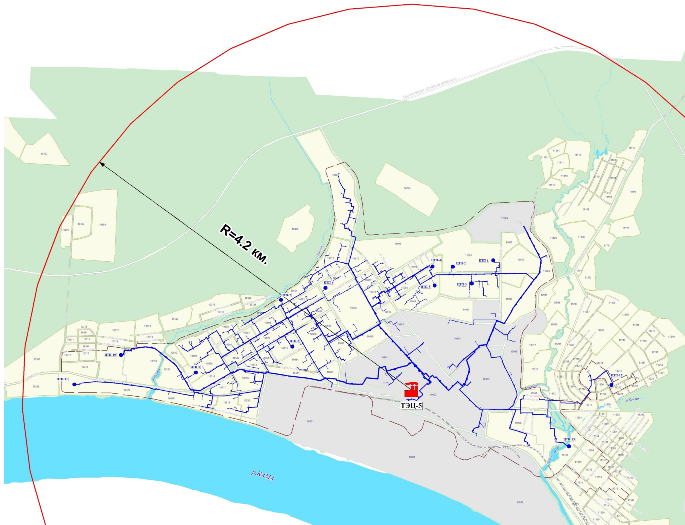
Рисунок 2.1 - Схема тепловой зоны и радиуса эффективного теплоснабжения ЗТЭЦ-5
