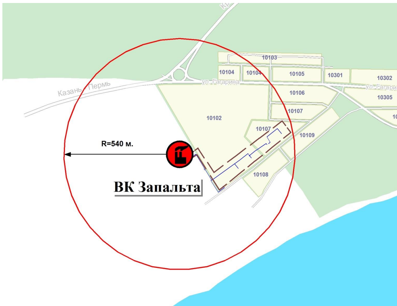
Рисунок 2.3 - Схема тепловой зоны и радиуса эффективного теплоснабжения ВК Запальта
