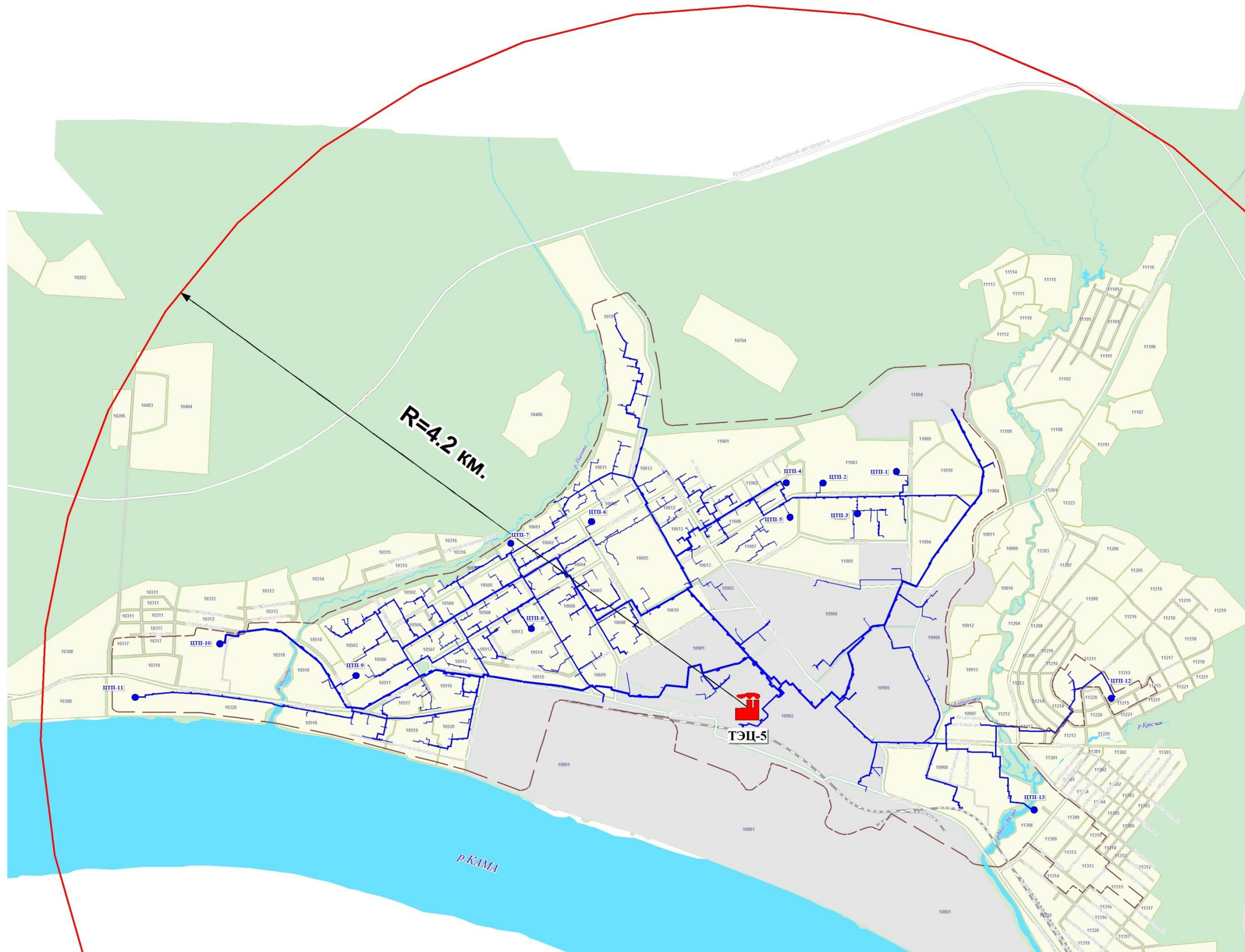
Рисунок 4 - Схема тепловой зоны и радиуса эффективного теплоснабжения ЗТЭЦ-5
